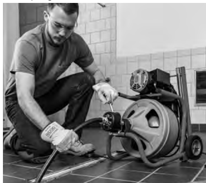
Figura 16 – Uso de la máquina con manguera-guía
