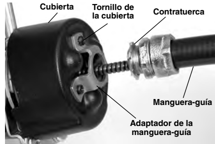
Figura 6 – Montaje de la manguera-guía al alimentador de cable
