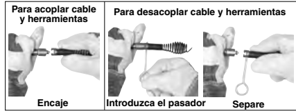
Figura 12 – Acoplamiento y desacoplamiento de herramientas al cable
