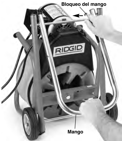
Figura 9 – Operación del mango
