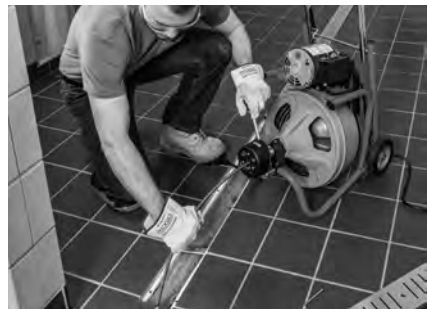
Figure 15 – Utilisation du K-400 avec AUTOFEED
