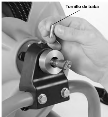
Figura 3 – Extraiga el tornillo de traba del cable, y deséchelo
