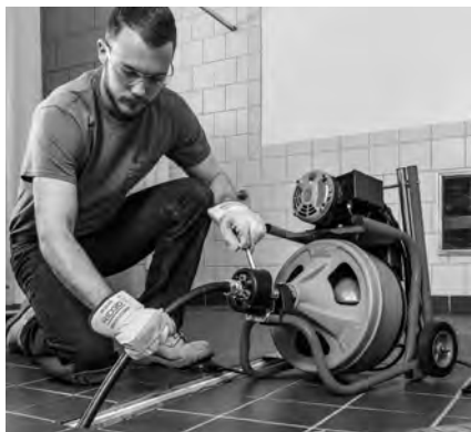
Figure 16 – Utilisation du guide-câble
