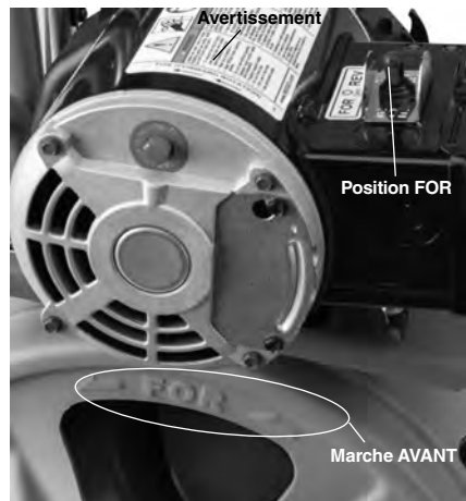
Figure 8 – Rotation du tambour en position FOR (marche avant)
