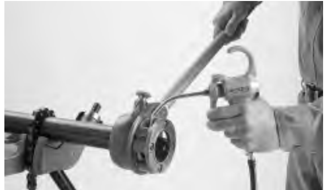
Figure 4 – Application de l'huile de coupe
