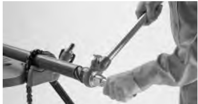
Figure 2 – Alésage de l'extrémité du tuyau
