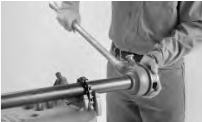
Figura 3 – Montaje de la Roscadora en el tubo
