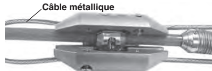
Figure 6 – Position de la bride du câble d'avancement dans la coquille
