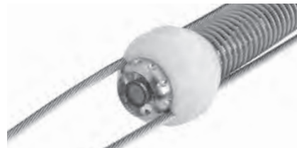
Figure 7 – Montage du guide sur la tête de caméra
