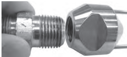
Figure 4 – Montage de l'adaptateur sur le cône
