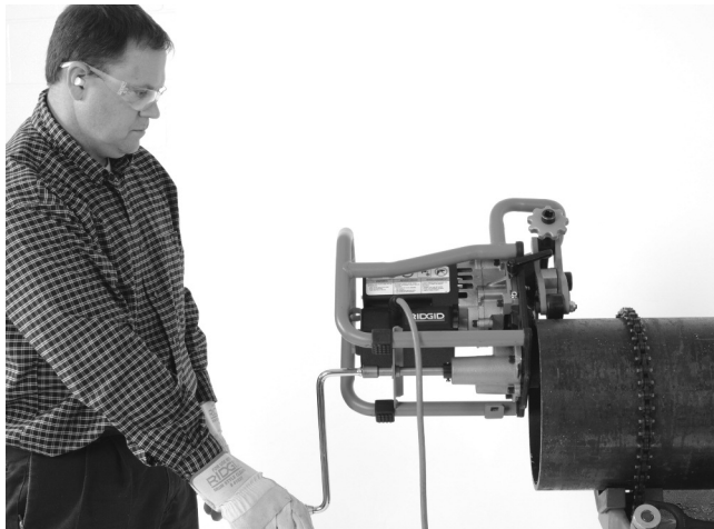
Figure 20A – Biseautage en cours (pièce fixe/machine mobile)
