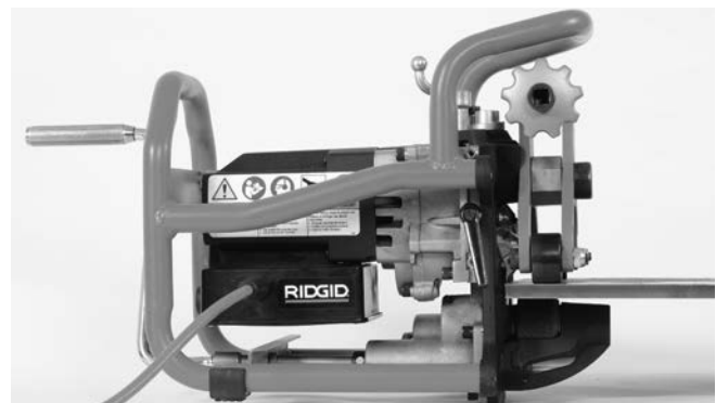
Figura 16B – Colocación de la biseladora sobre una chapa
