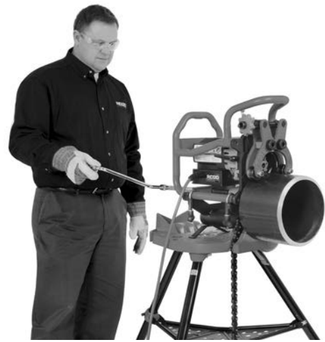
Figura 20C – Operación de biselado (biseladora fija/tubo en rotación)
