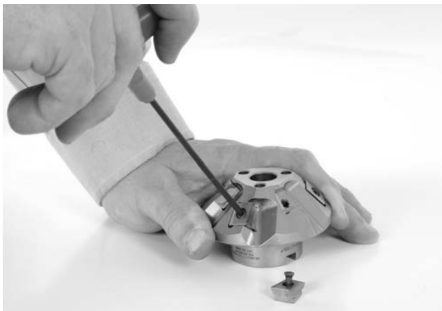
Figure 24 – Remplacement des couteaux
