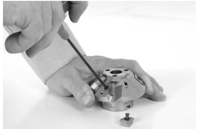
Figura 24 – Cambio de las placas de corte en el cabezal
