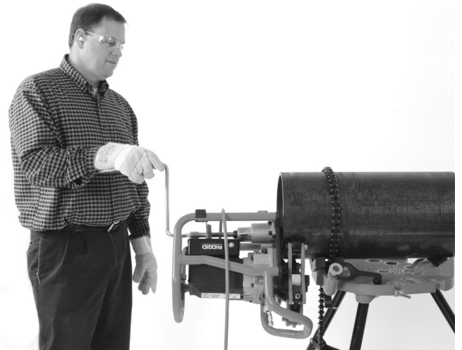
Figure 20B – Biseautage en cours (pièce fixe/machine mobile)
