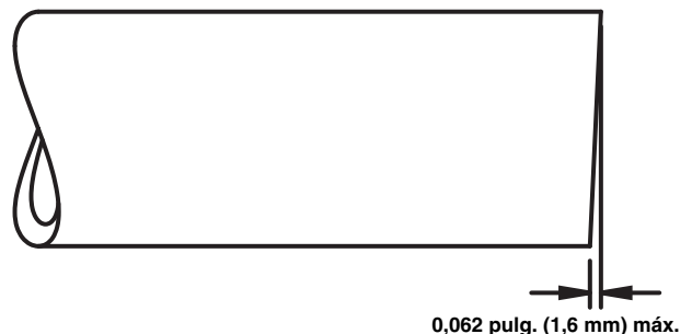
Figura 5 – Forma recta que debe tener el extremo del tubo
