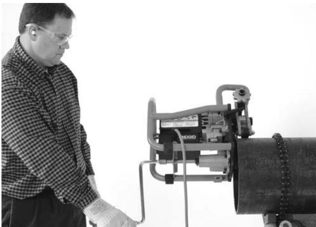
Figura 20A – Operación de biselado (pieza fija/biseladora móvil)
