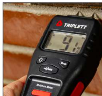
Moisture Meter (pin)
