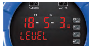
Modbus PV Input
